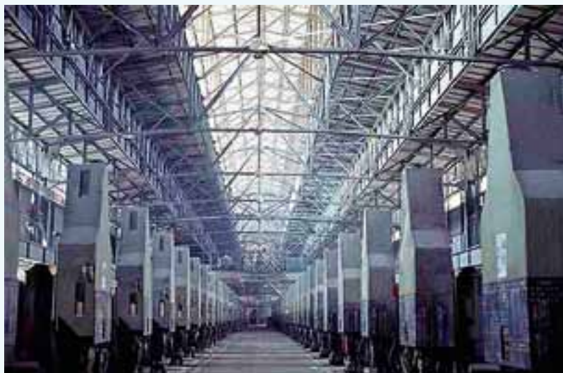
ΑτΕ: Ηλεκτρολυτικά κελιά (λεκάνες) στην διαδικασία της ηλεκτρόλυσης
